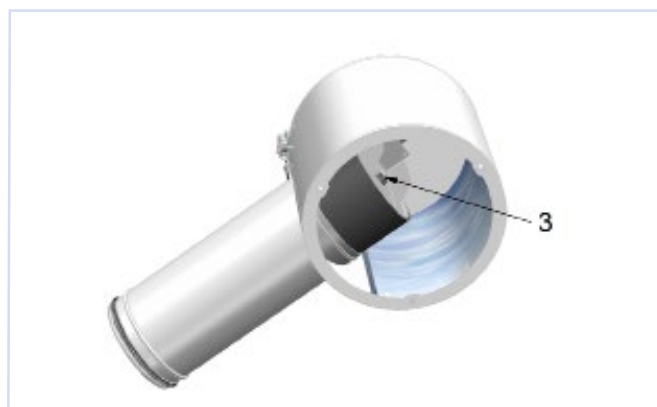
Bild 8, Avlägsna vingmuttern (6 mm) från spjället (3) och dra spjället till den bakre positionen. Ställdonet och spjället har nu lossats från sargen. (MI)
