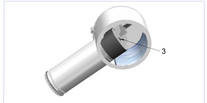
Bild 10, Avlägsna vingmuttern (6 mm) från spjället (3) och dra spjället till den bakre positionen. Ställdonet och spjället har nu lossats från sargen. (MI)
