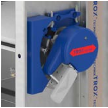
FK2-EU med smeltesikring for 72 °C eller 95 °C
