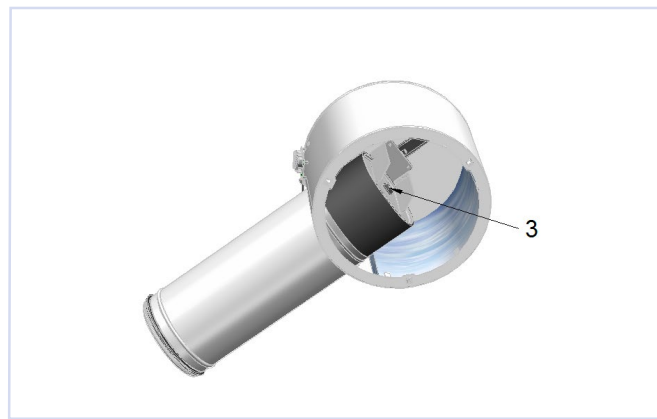
Figur 10, Fjern vingeskruen (6mm) fra spjeldet (3) og dra spjeldbrakett til bakre stilling. Aktuator og spjeld er nå løse fra sarg. (MI)
